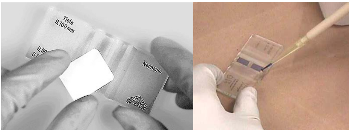
Figura 1.4: Vista de un hemocitómetro con su cubreobjetos especial (izquierda) y forma de llenar la cámara por un borde, con una micropipeta, tocando la muesca o cuña lateral por debajo del cubreobjetos (derecha).
