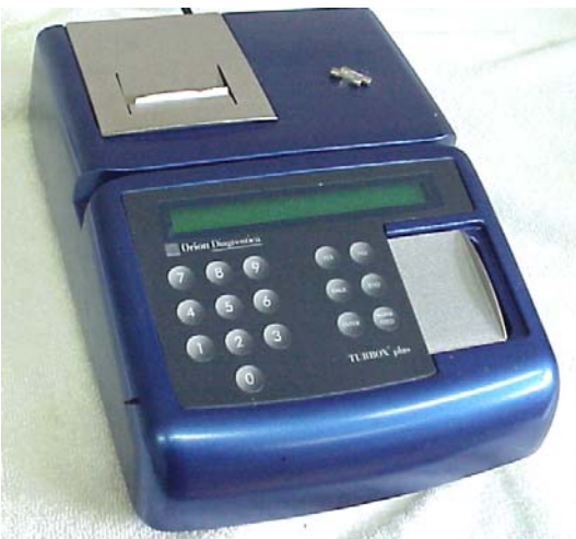
Figura 5.3: El Turbox ® (Orion Diagnostics) es un nefelómetro simple que se basa en lecturas de punto final para la determinación de inmunoglobulinas séricas (IgG, IgA, IgM) y algunas otras determinaciones de interés en el laboratorio clínico.
